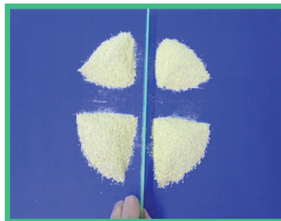
Figura 9 e 10. Divisão em 4 partes iguais com o auxílio de uma régua.
