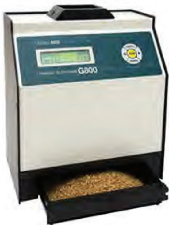
Figura 12. Aparelho utilizado para determinar a umidade no grão de milho
