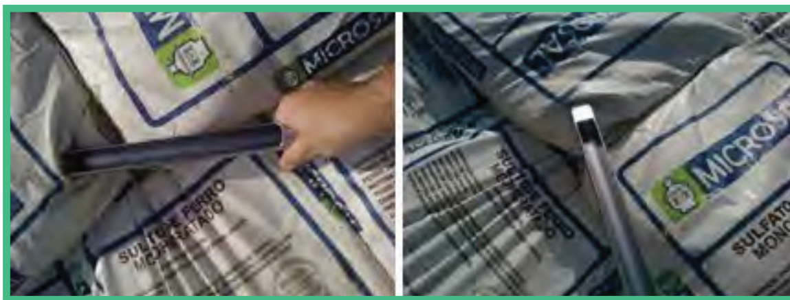
Figura 4. Utilização do calador simples na posição diagonal, posicionando-o no canto da sacaria.
